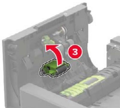
**7** Inserte la cubierta del rodillo de carga del ADF hasta que *encaje* en su sitio.
