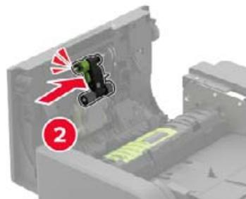
**7** Inserte la cubierta del rodillo de carga del ADF hasta que *encaje* en su sitio.
