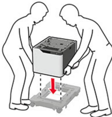
**5** Alinee la impresora con la bandeja y, a continuación, baje la impresora hasta que *encaje* en su sitio.
