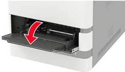
2 Ajuste las guías para que coincidan con el tamaño del papel que va a cargar.
