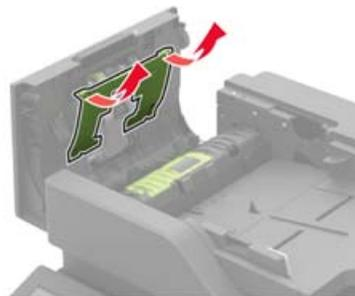
**4** Retire el rodillo de carga del ADF usado.
