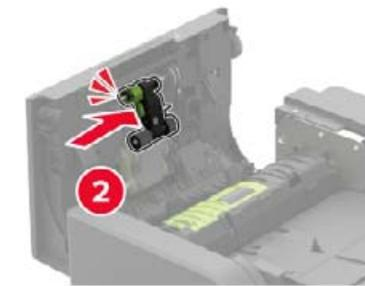
7 Inserte la cubierta del rodillo de carga del ADF hasta que *encaje* en su sitio.
