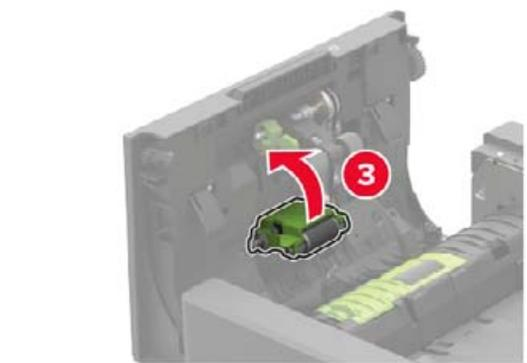
**7** Inserte la cubierta del rodillo de carga del ADF hasta que *encaje* en su sitio.
