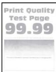
**Nota:** Antes de resolver el problema, imprima las páginas de prueba de la calidad de impresión. En el panel de control, vaya a **Valores > Solución de problemas > Páginas de prueba de la calidad de impresión**. En los modelos de impresora sin pantalla táctil, pulse
