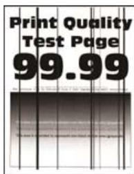
**Nota:** Antes de resolver el problema, imprima las páginas de prueba de la calidad de impresión. En el panel de control, vaya a **Valores > Solución de problemas > Páginas de prueba de la calidad de impresión**. En los modelos de impresora sin pantalla táctil, pulse
