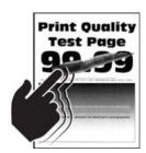
**Nota:** Antes de resolver el problema, imprima las páginas de prueba de la calidad de impresión. En el panel de control, vaya a **Valores** > **Solución de problemas** > **Páginas de prueba de la calidad de impresión**. En los modelos de impresora sin pantalla táctil, pulse para navegar por los distintos ajustes.
