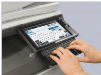
El teclado retráctil integrado simplifica las entradas de dirección de correo electrónico y asunto, así como las tareas repetitivas de escaneo y autenticación del usuario.
